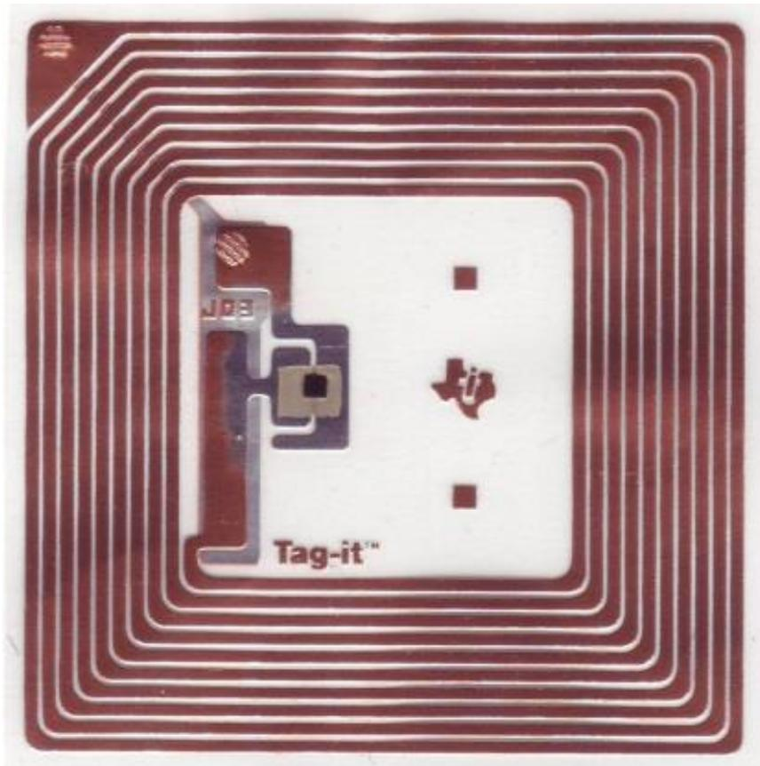
Abbildung 22: RFID-Transponder Mikrochip
